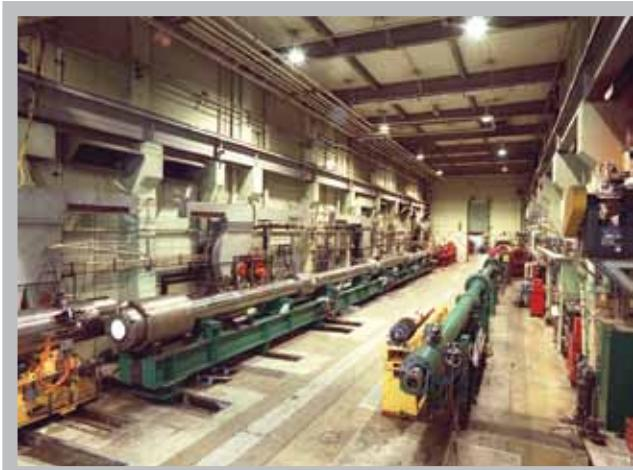
Een Light Gas Gun die gebruikt wordt op Arnold Air Force Base en waarmee snelheden tot 7 km/s bereikt worden. [USAF]
